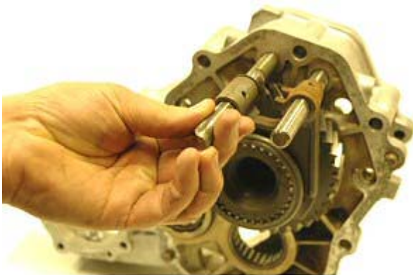
Step 29: Remove 2wd/4wd shift fork.
