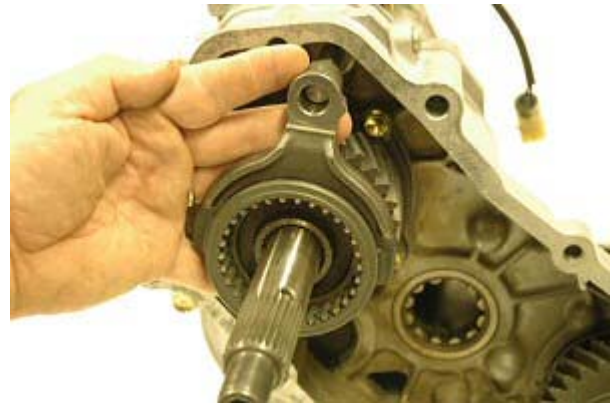
Step 10: Remove 2wd/4wd shift fork and shift collar.
