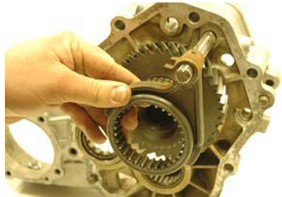
Step 30: Remove hi/lo shift fork and shift collar.
